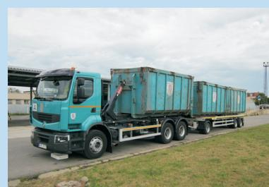
K odvozu odpadu k energetickému využití v SAKO Brno využíváme od loňského roku dva speciální taahače Renault Premium Lander s hákovým nosičem kontejnerů a točnicovým přívěsem. Maximální přepravované množství je 20 tun.
